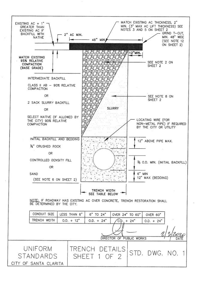
MATERIAL AND COMPACTION REQUIREMENTS FOR TRENCH BACKFILL
